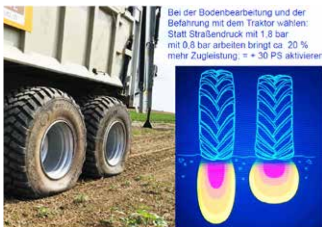
Mit dem richtigen Reifendruck den Boden schonen und die Zugleistung erhöhen
