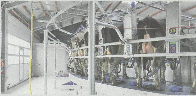
Herzstück des neuen Melkzentrums ist ein Außenmelkerkarussell mit 50 Melkplätzen. Zum Komplex gehören auch Büro- und Sozialräume.
