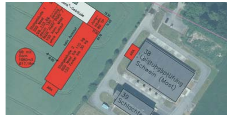
Abb. 1: Iden, ZTT der LLG, NEUBAU Schweinemaststall Variante 7 mit 600 Mast-, 80 Jungsau-, 120 Ferkelplätzen konventionell und Abluftreinigung, 150 Mastplätzen konventionell mit Außenklimareiz und 150 ökologische Mastplätzen mit Auslauf; ANBAU Abluftreinigungsanlage am vorhandenen Maststall; Stand: August 2020
